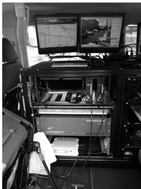
図6 MMSの室内の機器
