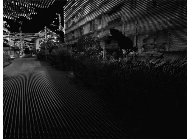
図9 図8へのレーザー測定点の重ね合わせ
