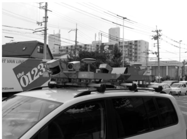
図4 MMSの計測機器
